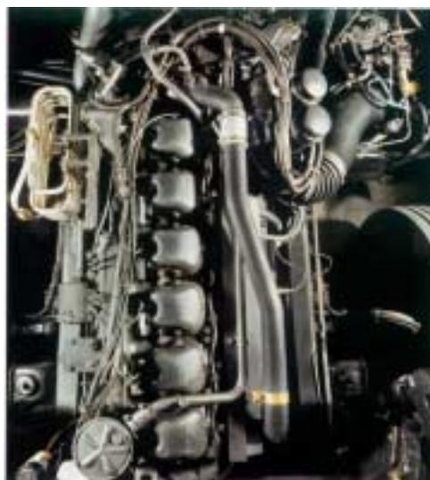
Fotografia 2 – Motor E 2866 (montagem vertical)
